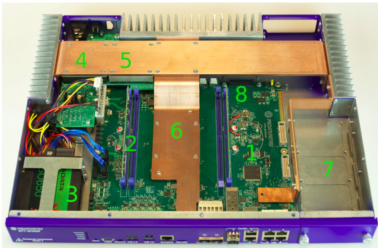
Рис. 11: Компоновка элементов внутри корпуса аппаратной платформы UNA
