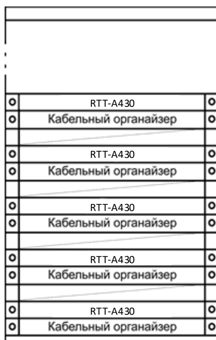
Рисунок 9 – Размещение коммутаторов в стойке
