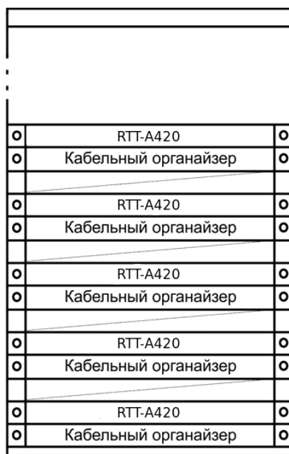
Рис. 26 – Размещение коммутаторов RTT-A420 в стойке
